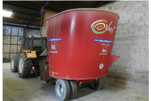
↑ Mélangeuse bol pour ration unique.
