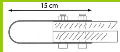
Les ferrures d'assemblage sont en fer plat, plié en U, et percé pour être boulonné sur les claies. Pour l'assemblage des claies, les piquets en forme de T sont les plus pratiques.
